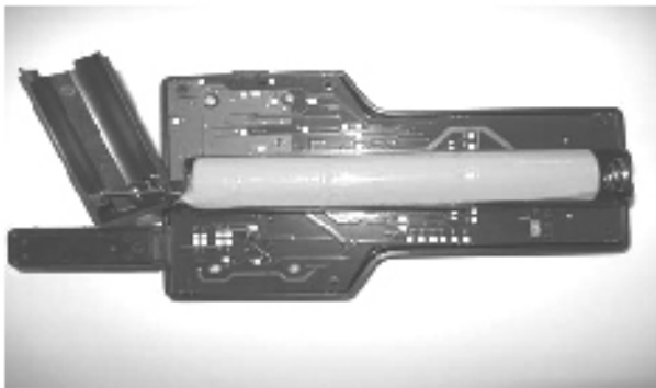
Illustration du bloc-piles de recharge installé
